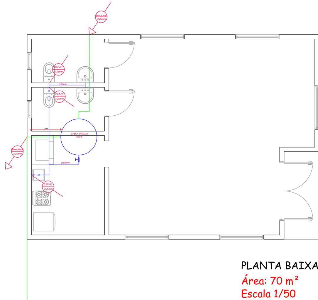
PLANTA BAIXA - HIDRAULICA
