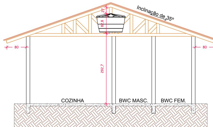
CORTE INDICANDO ALTURA DA CAIXA D'ÁGUA
